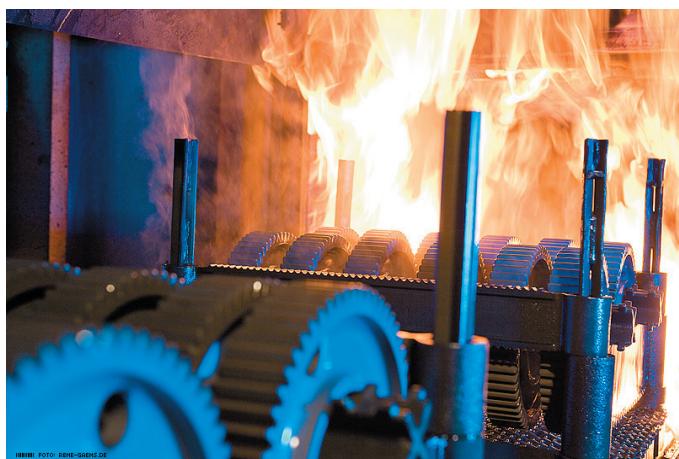
Bestückung einer Ofenanlage in der Härterei VTN Wilthen GmbH
